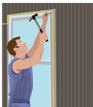
Опасно вбивать гвозди вблизи электрической проводки
